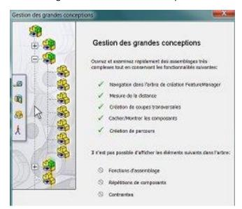
Après ouverture dans ce mode, il est possible de sélectionner les éléments (pièces et/ou sousensembles) devant être chargés en mémoire pour édition de l'assemblage, à partir des commandes d'ouverture sélective du mode.
