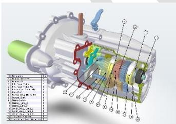
En utilisant SOLIDWORKS Composer, vous pouvez générer une nomenclature et des repères rapidement en utilisant les propriétés personnalisées de SOLIDWORKS.
