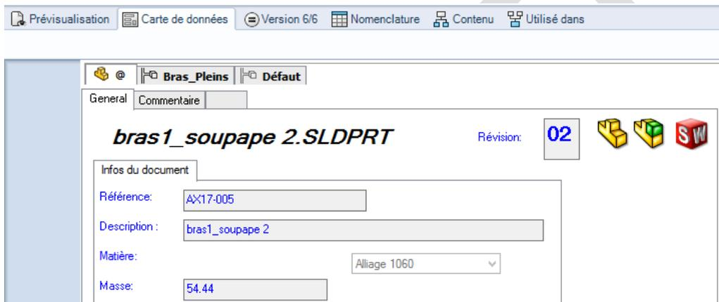
Il est possible de désactiver cette option. Ceci vous permet de choisir l'onglet à afficher comme par exemple l'onglet « @ ». Pour cela, il suffit de dérouler le menu : « Afficher/Options/Sélectionner la configuration active »
