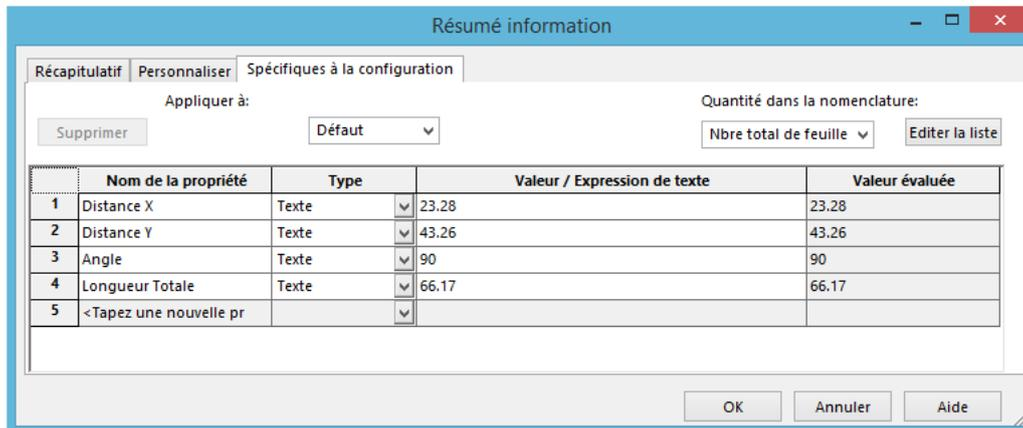
Il est possible de demander de générer les propriétés de la boîte englobante du volume de la pièce avec ou sans décalage dans les directions X, Y, Z. Si la pièce comporte plusieurs corps volumiques, la boîte englobante prendra l'ensemble des corps.
