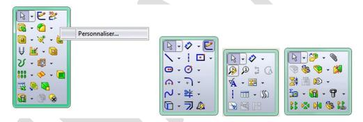
Exemple de menu dans le contexte d'une pièce, d'une esquisse, d'une mise en plan et d'un assemblage
