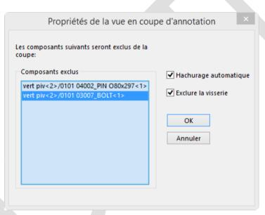
A cette étape, il est encore possible de sélectionner des composants à ne pas couper lors de la réalisation de la coupe de mise en plan. Par ailleurs, vous retrouvez également les options « standard » de mise en plan comme le hachurage automatique et l'exclusion des visseries.
